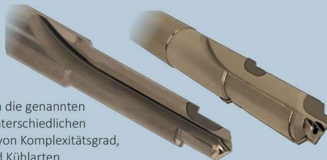
Wir konstruieren die genannten Werkzeuge in unterschiedlichen Kombinationen von Komplexitätsgrad, Arbeitslänge und Kühlarten (Kühlung direkt an den Schneiden, Kühlung im Raum zur Spanabfuhr, unterschiedliche Ausführungen spezieller Kühlöffnungen).
